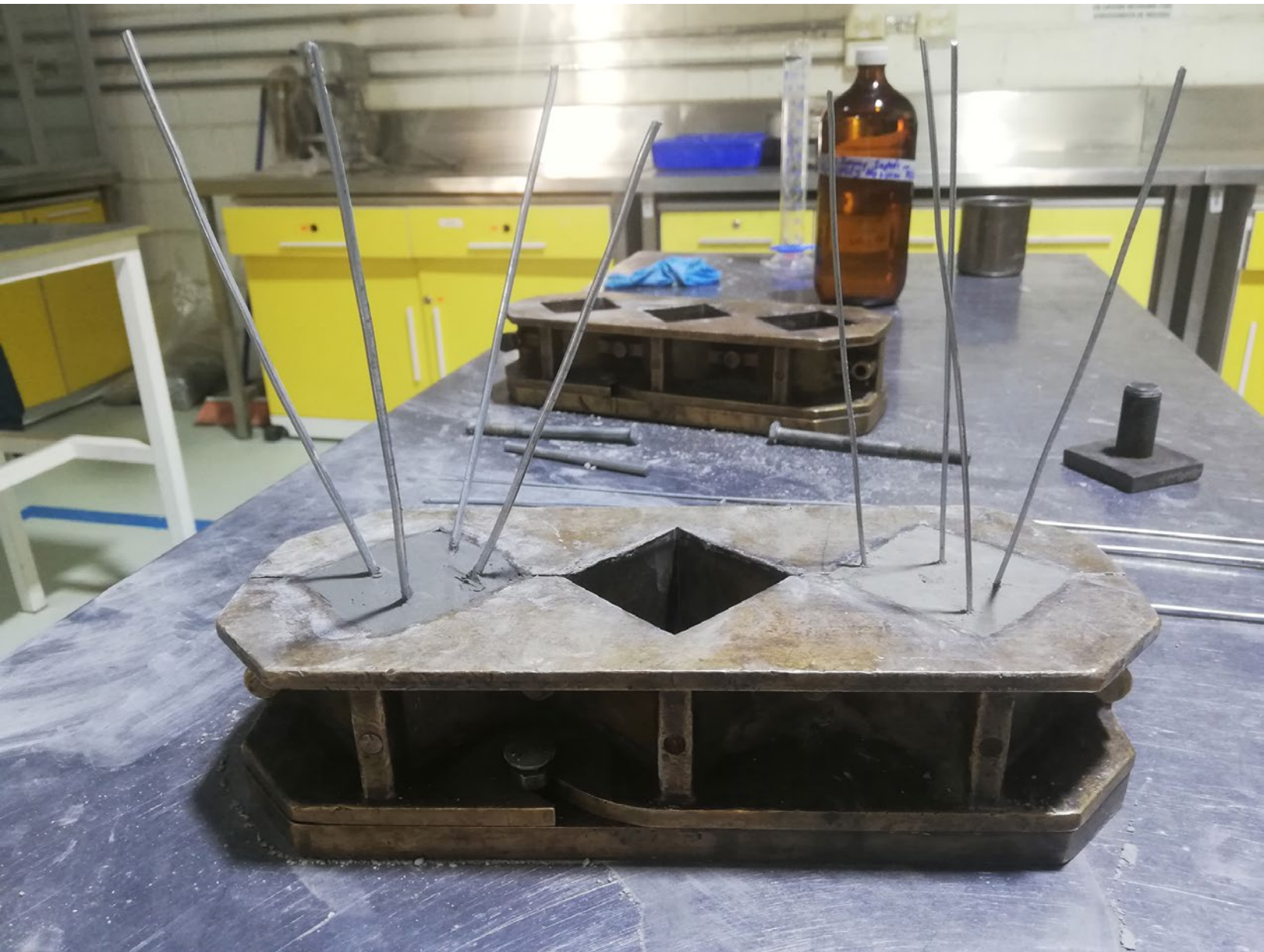
Imagen 6. Elaboración de módulos cúbicos de biocemento. Las piezas que se muestran en la imagen se elaboraron usando moldes de bronce e insertando piezas de alambre. Los relaves pulverizados se someten a un proceso de solidificación mediante la adición de un cultivo de la bacteria biocementante denominada Sporosarcina pasteurii .
