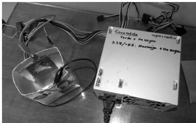
Sistema de grabado electrolítico, con una fuente de poder de una computadora y una caja tetrabrik como cubeta. El electrodo positivo (cable rojo) se conecta a la placa de grabado y el negativo (negro) a la placa receptora, en este caso una hoja de papel aluminio. El cable verde de la fuente se ha unido a uno de los cables negros para encenderla.
